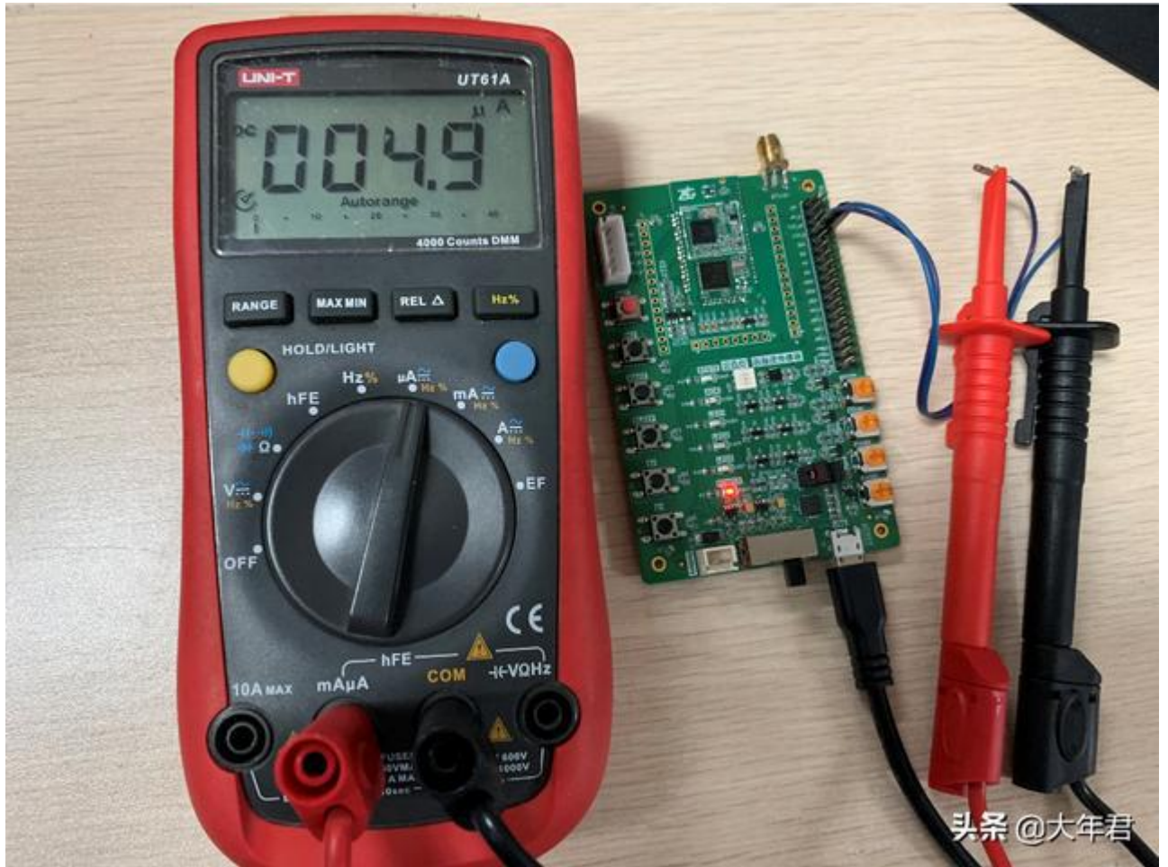
图 5 产品 A 的 IO 配置不当测试结果
